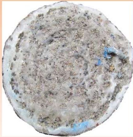
1週間稼働後のメッシュ汚れ状況
