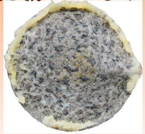
パーージ洗淨直後のメッシュ汚れ状況
